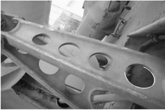
图 2 不在同一平面的椭圆轮廓 Fig.2 Non-coplanar ellipse contour
